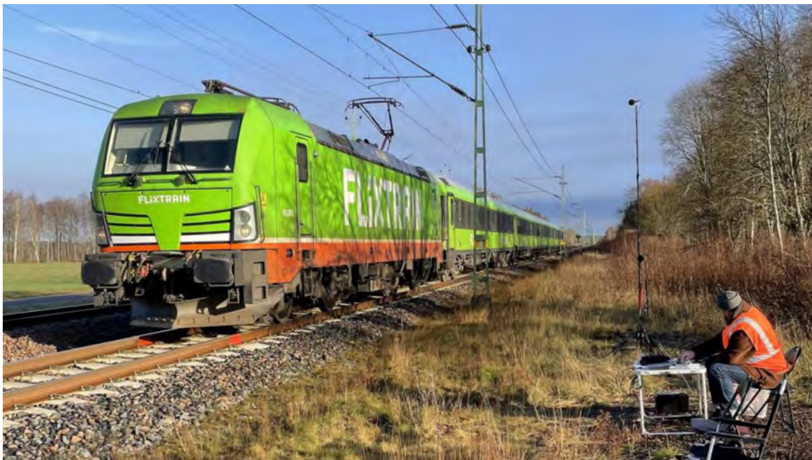
Figur 3. Mätning av bulleremission från Flixbus persontåg utmed Västra stambanan.
