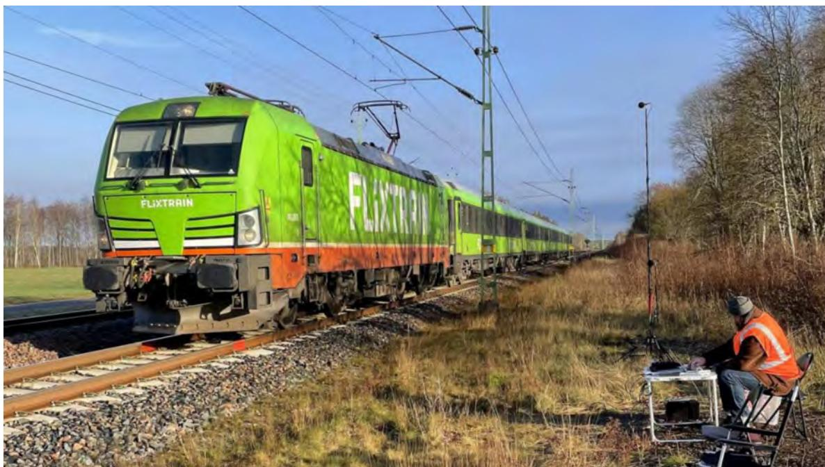
Figur 3. Mätning av bulleremission från Flixtrain personståg utmed Västra stambanan.
